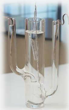
Rys. 1. Specjalistyczne naczynko do badań elektrochemicznych na spolaryzowanych granicach fazowych typu ciecz-ciecz.
