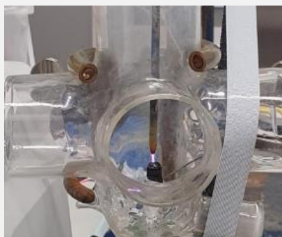
Rys. 1. Zdjęcie komory do generowania zimnej plazmy atmosferycznej typu pm-rf-APGD
