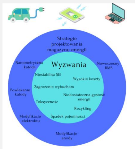
Rys. 1. Wyzwania technologiczne projektowania nowego magazynu energii oraz strategie na jego zaprojektowanie (opracowanie własne).
