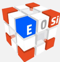
Rys. 1. Schematyczna reprezentacja struktury kubicznego heterosilsekwioksanu
